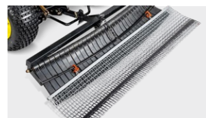
Aizmugurē uzstādāma elastīgā lāpsta lauka līdzināšanai
